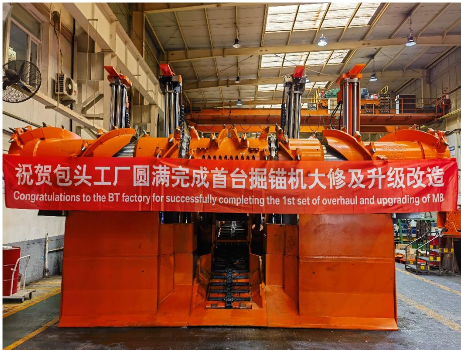
集成了 3 根 HFX（左面三个）和 1 根 TLX（右一）的掘锚机
