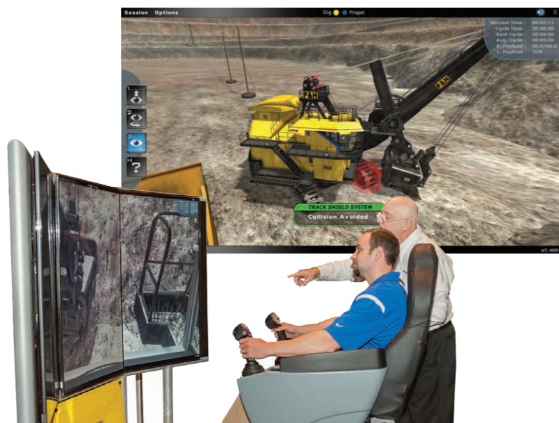
Система Track Shield встроена в наш усовершенствованный тренажер работы на экскаваторе. Ее можно включать и отключать, чтобы помочь оператору испытать и освоить систему.
