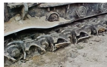
Трещины или закругления
