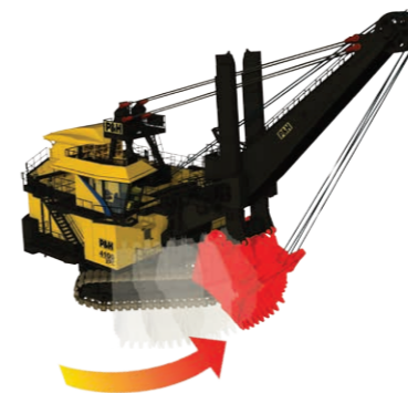
Контакт ковша с башмаком гусеницы может произойти при копании в непосредственной близости от гусеничных траков и при «возврате в положение сборки» во время выемки грунта.
