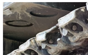
Повреждения отверстий под палец
