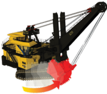
在非常接近履带的位置挖掘，在挖掘周期的“返回翻转”阶段，铲斗都可能和履带板接触。
