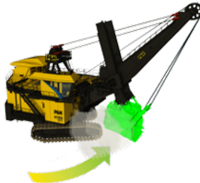
Track Shield系统帮助操作员生成替代路径。
