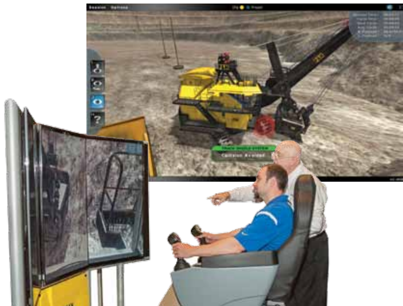
我们先进的电铲模拟器中设计有履带保护装置。它的开关可以协助操作员了解和熟悉系统。
